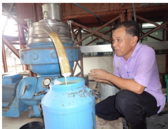
ภาพที่ 5 น้ำยางชั้นที่ผลิตได้ปราศจาก TMTD/ZnO
